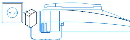
Рисунок 7 – Подключение блока питания
