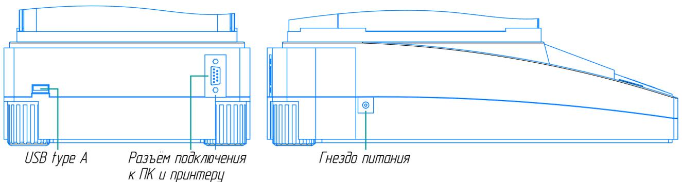
Рисунок 2 – Задняя и боковая панель весов
