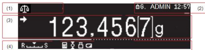
Рисунок 4 – Дисплей весов (изображение для режима стандартного взвешивания)
